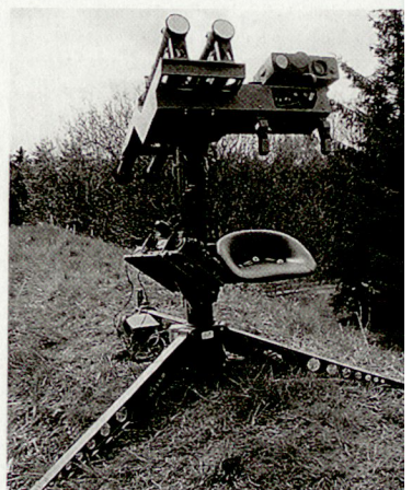
Zwillings-Abschussvorrichtung für die Flab-Lenk Waffe «Stinger».
