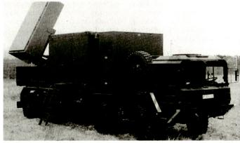
Artillerieradar «Cobra» mit phasengesteuerter Antenne.
