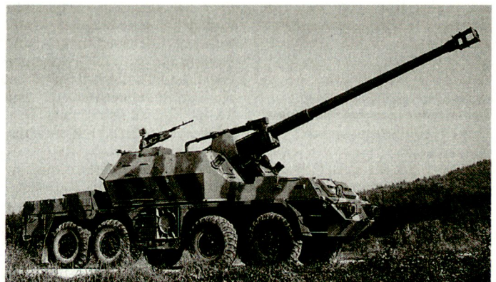
Selbstfahrkanone 155 mm «Zuzana» auf Geländelastwagen «Tatra-815».
