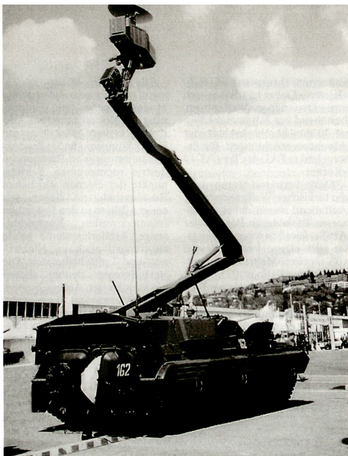
Aufklärungsschützenpanzer «Snezka» mit ausgefahrenem Teleskopmast.
