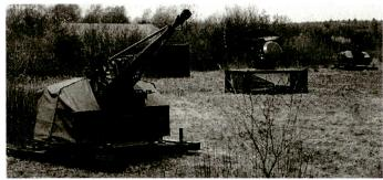
Fliegerabwehrsystem «Skyshield» mit 35-mm-Revolverkanone.
