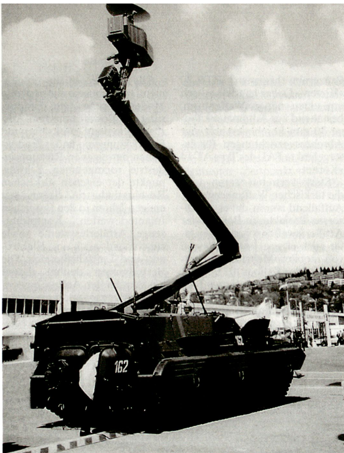
Aufklärungsschützenpanzer «Snezka» mit ausgefahrenem Teleskopmast.
