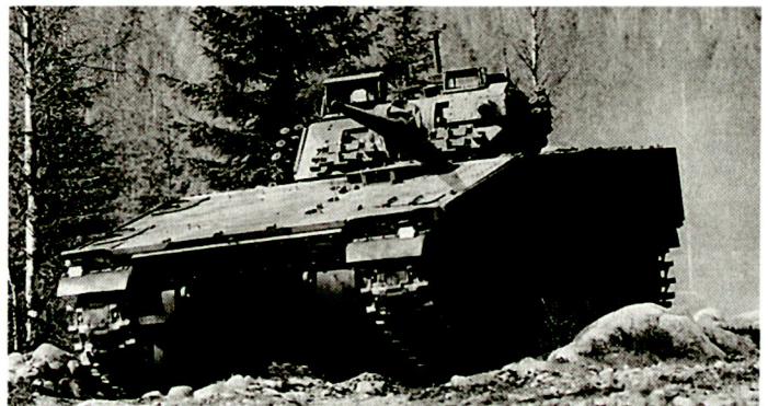
Kampfschützenpanzer CV-9030, ausgerüstet mit Automatenkanone 30 mm.
