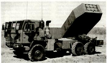
Mehrfachraketenwerfer HIMARS, eine leichte Version des MLRS.
