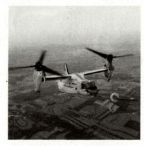
V-22 OSPREY: Dank um die Querachse drehbaren Propeller verbindet dieses Flugzeug Vorteile des Flächenflugzeuges und des Helikopters in einer zukunftsweisenden Konstruktion.
