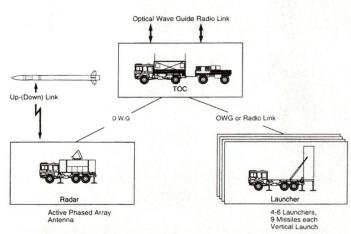
System-Konfiguration des neuen Luftabwehrsystems MEADS.
