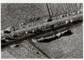
Abb. 3: SAR-Aufnahme mit einer Bodenauflösung von 40 cm in Flugrichtung und 2 m quer dazu. (Dornier GmbH/RSL)
