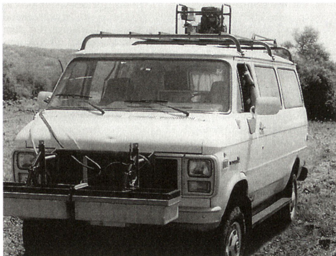
«Bodendurchdringendes Radargerät» GPR zur Minenaufklärung, das an jedem Fahrzeug angebracht werden kann.
