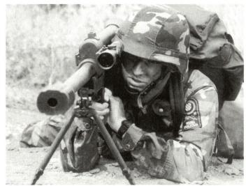
Prototyp eines kroatischen Scharfschützengewehres vom Kaliber 20 mm.
