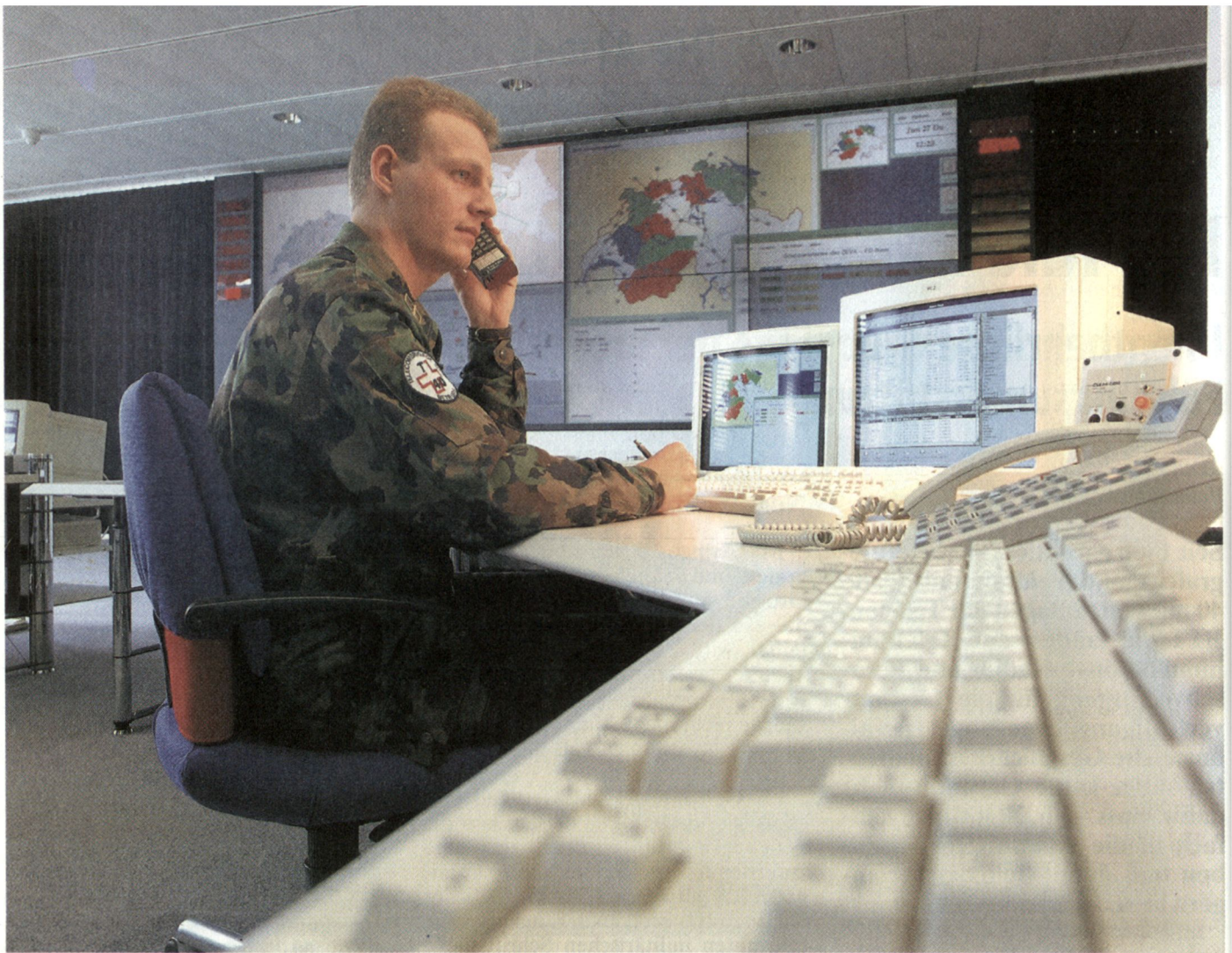
Das eigentliche Nervenzentrum: mittels Netzmanagement werden Zustand und Betrieb des gesamten Telecom-Netzes gesteuert und überwacht. (Aufnahmen GD PTT Reprotechnik)
