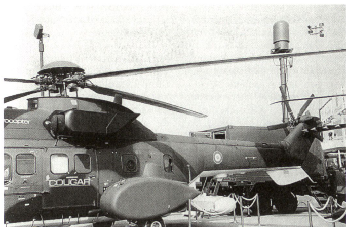
Aufklärungssystem Horizon, bestehend aus Helikopter Cougar und automatisierten Bodenstationen.
