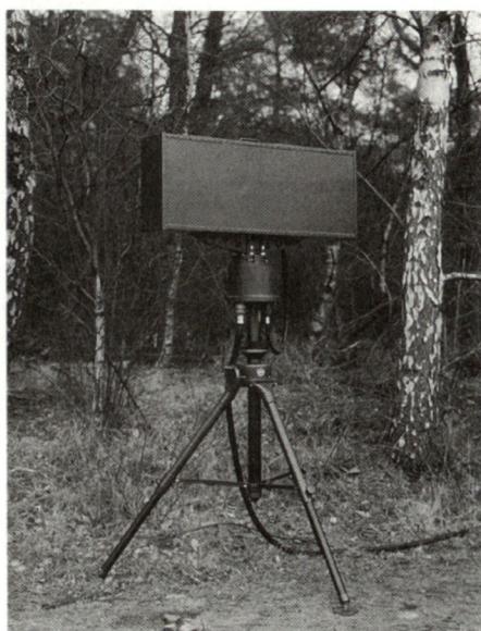
Das tragbare Gefechtsfeldüberwachungsradar «Scout», entwickelt durch die holländische Firma Signaal, ist ein Beispiel der Neuentwicklungen in diesem Bereich.
