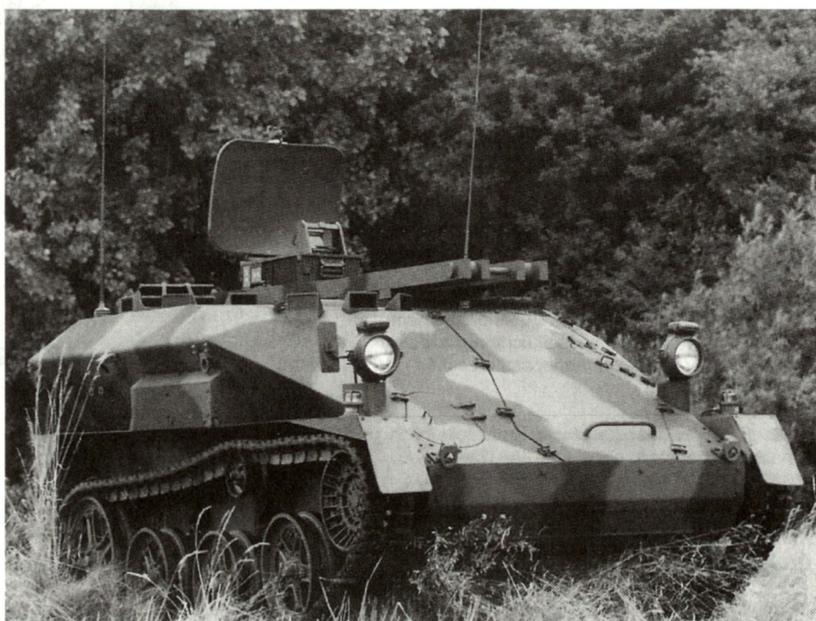
Prototyp des mobilen Überwachungsradars «Ratac-S» auf dem Luftlandepanzer «Wiesel».
