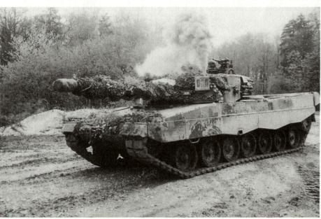
Abb. 1: Kampfpanzer mit Schiess- und Treffersimulator.
