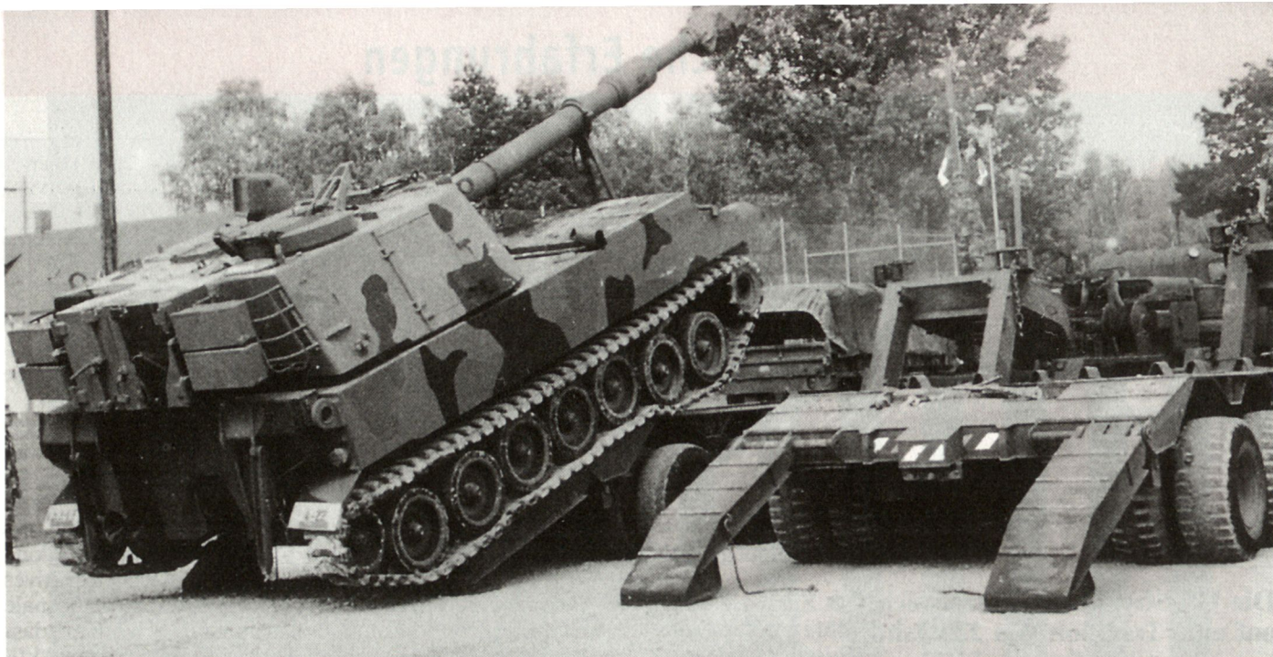
Panzerhaubitze M-109A2 beim Verladen auf das Transportfahrzeug M-746.
