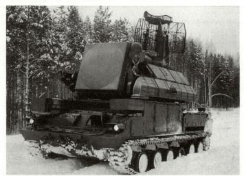
Version des Raupenfahrgestells GM-569 als Träger von Radargeräten für das Flab-/ Flugkörperabwehrsystem TOR.
