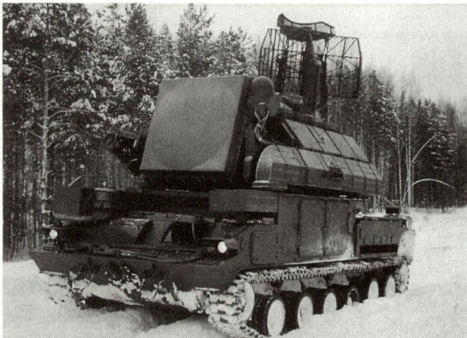
Version des Raupenfahrgeräts GM-569 als Träger von Radargeräten für das Flab-/ Flugkörperabwehrsystem TOR.
