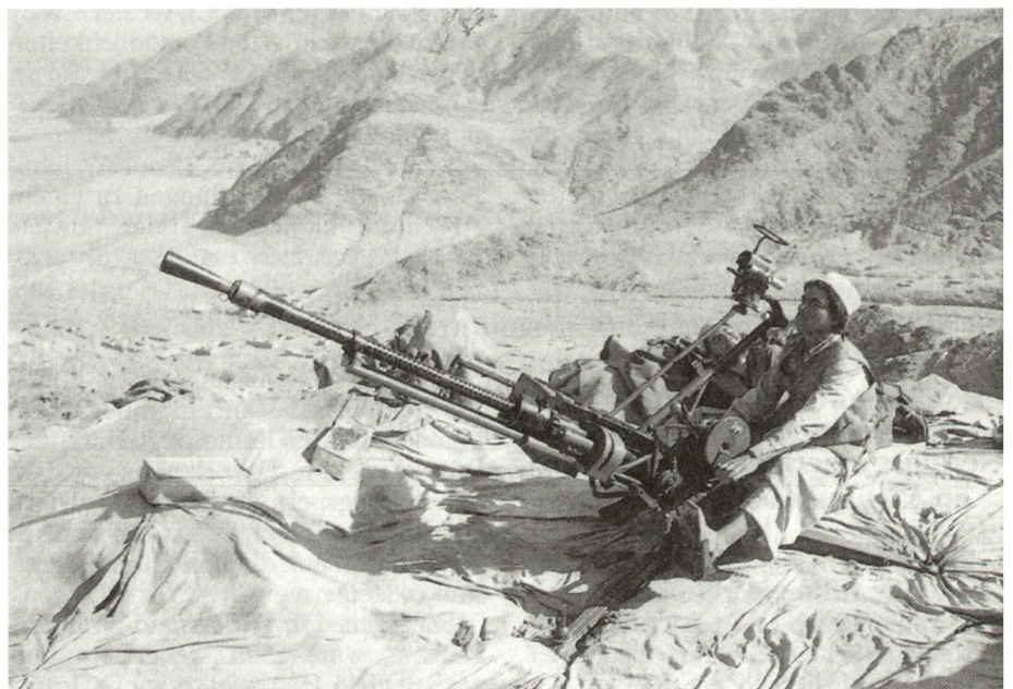
Überschweres Flab-Maschinengewehr ZPU 14,5 mm.
