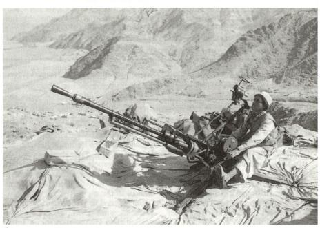
Überschweres Flab-Maschinengewehr ZPU 14,5 mm.
