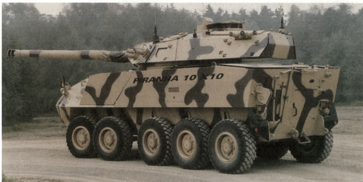
Prototyp des neuen Piranha (10×10), ausgerüstet mit Kanone 105 mm.
