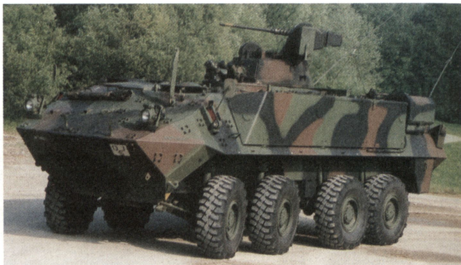
Radschützenpanzer Piranha (8×8) mit Mg 12,7 mm, der bei der Schweizer Armee eingeführt wird.
