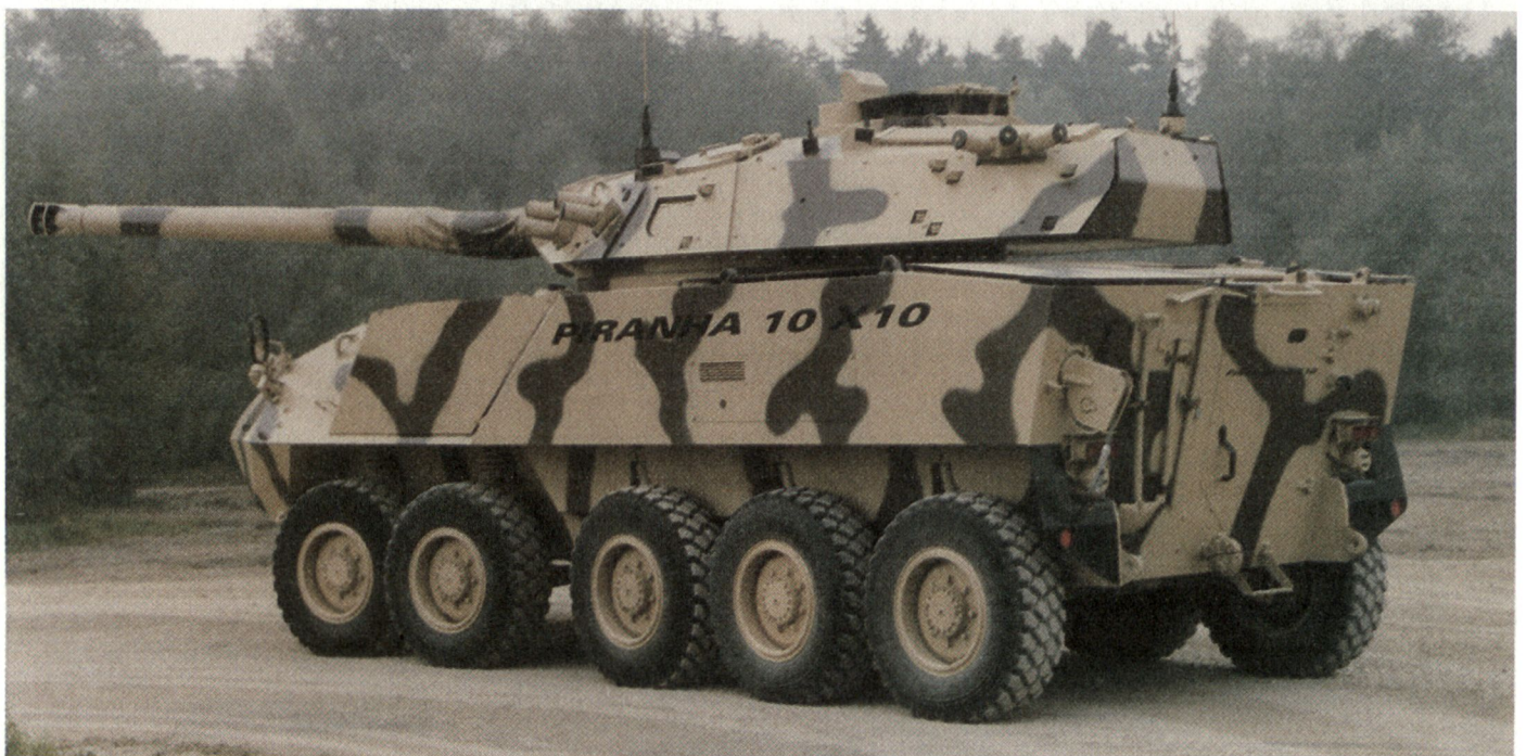
Prototyp des neuen Piranha (10x10), ausgerüstet mit Kanone 105 mm.
