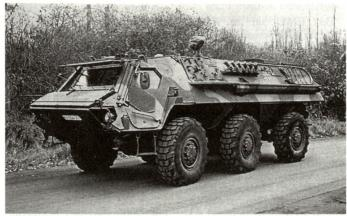
Aufklärerversion des Transportpanzers Fuchs, ausgerüstet mit modularer Zusatzpanzerung gegen Beschuss, Splitter und Minen.
