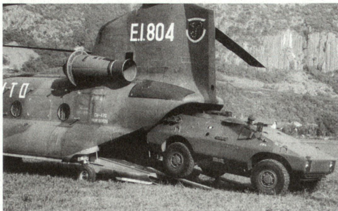
Der leichte Schützenpanzer Puma (4x4) kann mit Transporthelikoptern (Bild CH-47) verschoben werden.
