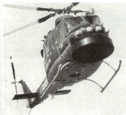
Beobachtungshelikopter Creso, ausgerüstet mit modernem Überwachungsradar.
