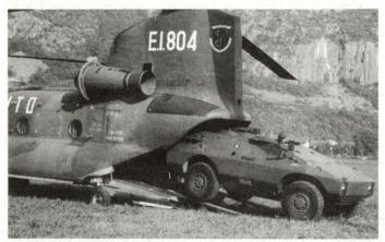
Der leichte Schützenpanzer Puma (4×4) kann mit Transporthelikoptern (Bild CH-47) verschoben werden.
