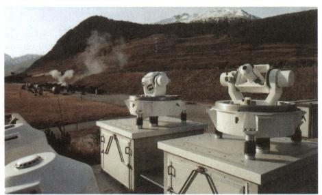
Abb. 2: Elektro-Optik-Einheit für Ziel- und Schusserfassung der Schussfehlervermessungsund Trainingsanlage SVF 90 für Fliegerabwehrschiessplätze. (Oerlikon-Contraves)
