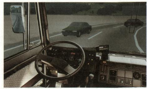
Abb. 3: Reale LKW-Führerkabine mit computer-generierter Sicht des Fahrsimulators ADAMS (Advanced Driving And Manoeuvering Simulator) für Lastwagen. ADAMS ist die zivile Version von FATRAN. (Oerlikon-Contraves)
