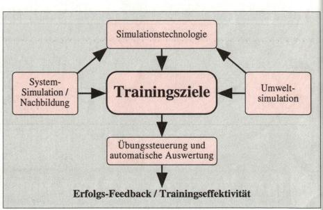
Abb. 1: Hauptelemente eines Ausbildungssimulators.
