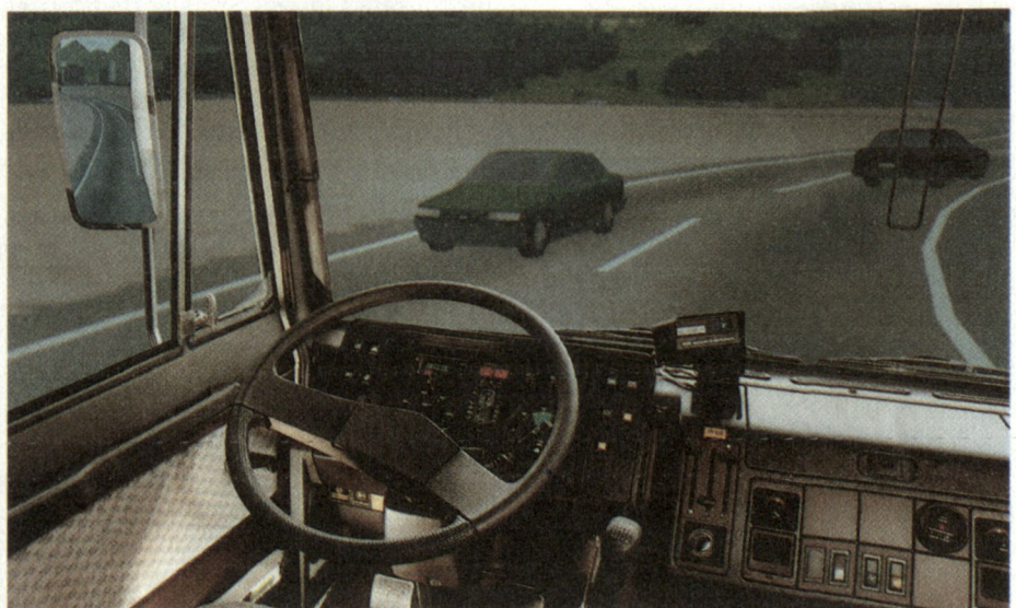
Abb. 3: Reale LKW-Führerkabine mit computer-generierter Sicht des Fahrertrainers ADAMS (Advanced Driving And Manoeuvring Simulator) für Lastwagen. ADAMS ist die zivile Version von FATRAN. (Oerlikon-Contraves)
