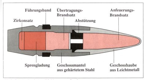
Abb. 2: Schnitt durch das «Multipurpose»-Geschoss.
