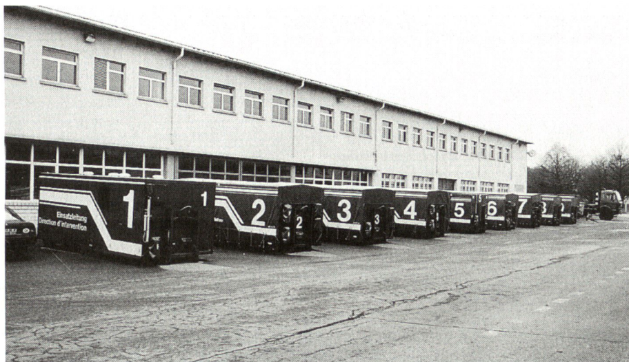
Für das Katastrophenhilferegiment wurden 3 Trägerfahrzeuge und 11 Wechselladebehälter (Welab) als Prototypausrüstung für ein Bataillon beschafft. (Welab 1: «Einsatzleitung», 2: «Chemie-/Strahlenschutz», 3: «Unterstützung», 4: «Beleuchtung/Strom», 5: «Wassertransport» [2x], 6: «Brandeinsatz» [2x], 7: «Überschwemmung», 8: «Umweltschutz», 9: «Sanitätsdienst». (BALST/KMV)
