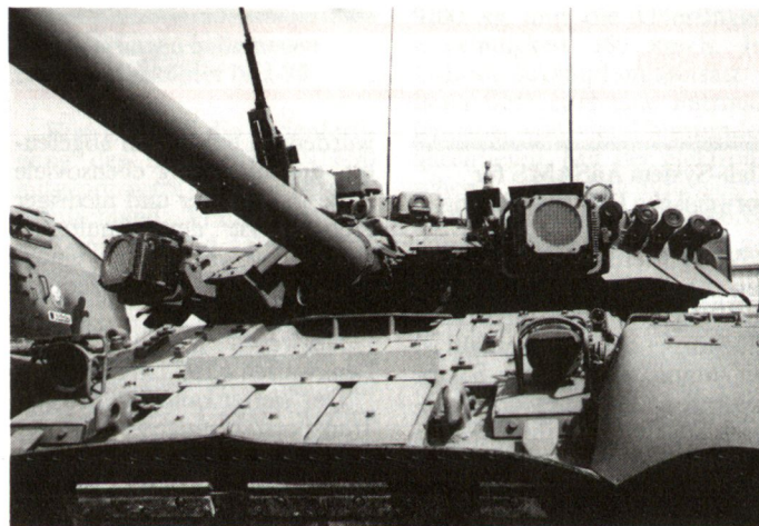
Abb.3: Modifizierter Kampfpanzer T-80UK ausgerüstet mit Lasersensoren (über Kanone) und IR-Strahlern (beidseitig Kanone).
