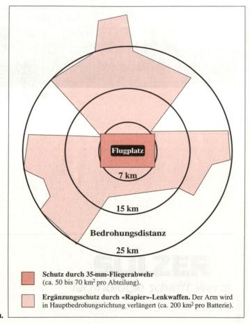
Abb. 1: Prinzipskizze Flugplatzschutz durch 35-mm-Fliegerabwehrkanonen und «Rapier»-Lenkwaffen.
