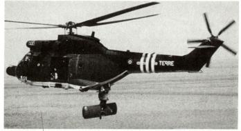
Helikopter Cougar mit Radar für Aufklärungssystem HORIZON.
