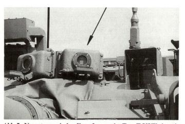
Abb. 5: Neuester russischer Kampfpanzer des Typs T-80UK, der mit aktiven Schutzkomponenten ausgerüstet ist. Darunter befindet sich auch ein Laserwarn- und -lokalisierungsgerät.
