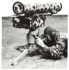
Abb. 4: Russisches PAL-System «Kornet» (AT-14), das mit einer Laser-Leitstrahllenkung (Laser Beam Rider) versehen ist.
