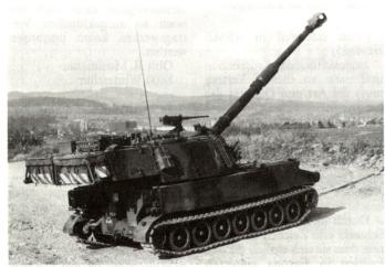
Kampfwertsteigerung Panzerhaubitze M-109. Äussere Merkmale: längeres Geschützrohr, Flecktarnanstrich und «Rucksack» am Turmheck, welcher ermöglicht, mehr Munition mitzuführen.
