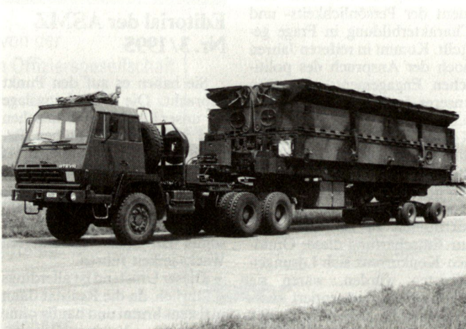
Schwimmbrücke 95. Sattelmotorfahrzeug mit Brückenmodul.
