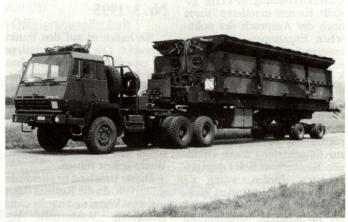
Schwimmbrücke 95. Sattelmotorfahrzeug mit Brückenmodul.
