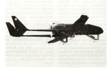
Aufklärungsdrohnensysteme 95 Ranger (ADS 95). Aufklärungsdrohne Ranger mit eingeklappten Landekufen.
