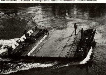
Schwimmbrücke 95. Verschieben des eingewasserten Moduls an die Brückenbaustelle.
