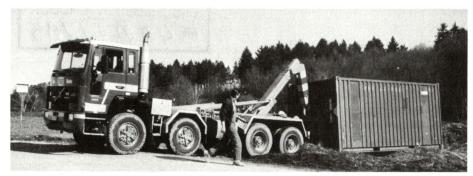
Abb. 2: Dank neuer Entwicklungen ist der Umschlag von Containern heute ohne komplizierte Einrichtungen auch im Truppen- und Feldeinsatz möglich.
