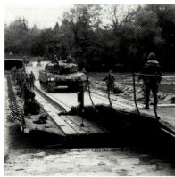
Mit dem Rüstungsprogramm 1995 werden unter anderem neun Schwimmbrücken 95 von je 100 m Länge zur Beschaffung beantragt. Versuche in den Rekrutenschulen haben gezeigt, dass mit diesem modernen Material die Überwindung eines Hindernisses von 100 m Breite gerade noch eine Stunde dauert. (Versuchsstab Genie)
