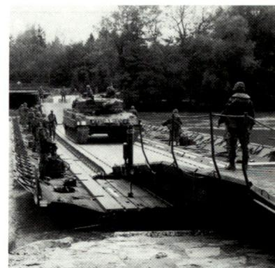
Mit dem Rüstungsprogramm 1995 werden unter anderem neun Schwimmbrücken 95 von je 100 m Länge zur Beschaffung beantragt. Versuche in den Rekrutenschulen haben gezeigt, dass mit diesem modernen Material die Überwindung eines Hindernisses von 100 m Breite gerade noch eine Stunde dauert. (Versuchsstab Genie)
