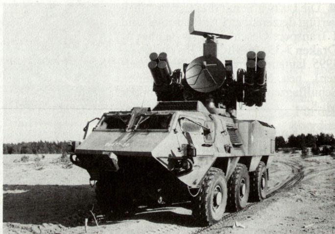
Abb. 5: Das französische Fliegerabwehrlenkwaffen-System «Crotale NG» ist eine der jüngsten Beschaffungen der finnischen Streitkräfte. Die Reichweite beträgt 10 km horizontal und 6 km vertikal.
