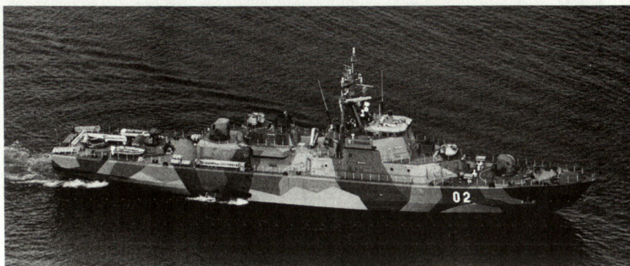
Abb. 4: Der Minenleger «Hämeenmaa» gehört zu den modernsten Schiffen der finnischen Marine. Er wurde 1992 in Dienst genommen, misst 76 m Länge und erreicht eine Geschwindigkeit von 20 Knoten.
