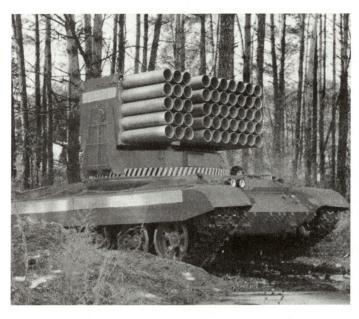
Abb. 4: Konversionsprodukt aus der Ukraine: Mobiles Feuerlöschfahrzeug auf Panzerfahrgestell.
