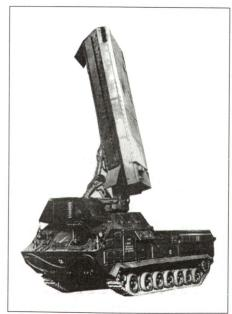
Abb. 3: Mobiles Überwachungsradarsystem 1L220-U.
