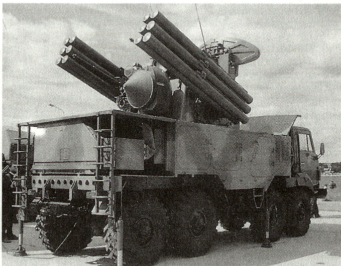
Das mobile Flab-System Pantzir verfügt über zwei Kanonen 30 mm und 12 Abschussvorrichtungen für Lenkwaffen. ■
