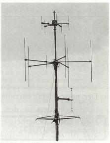
Abb.1: VHF/UHF-Empfangsantenne eines Erfassungspostens.
