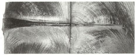
Abb. 3: Schusskanal eines Splitters in einem Simulans (Schussrichtung von links).
