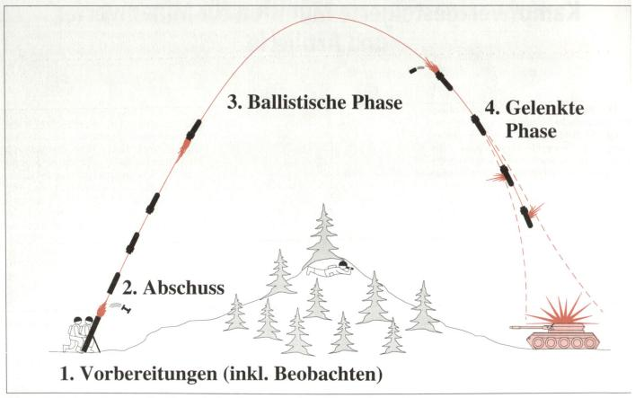
Schematische Darstellung des Funktionsablaufs endphasengelenkter Minenwerfermunition.
