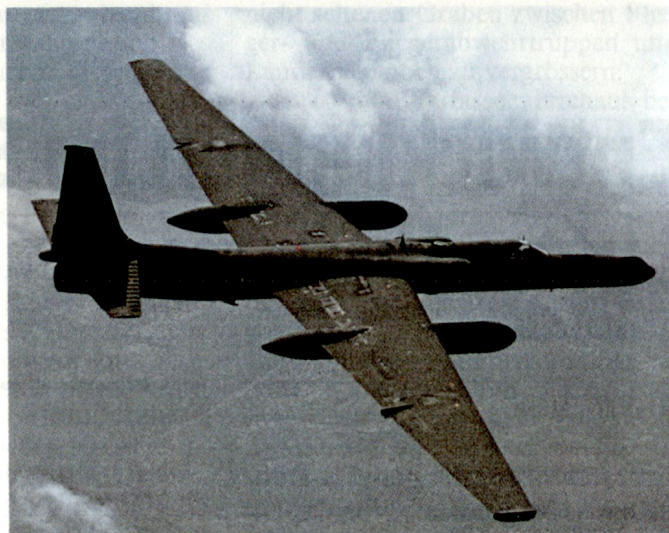
Abb. 2. Taktisches Luftaufklärungsflugzeug der USAF, Lockheed U-2R. (Länge 19,2 m; Spannweite 31,4 m; Höhe 5,2 m; Gipfelhöhe 21 400 m/M)
