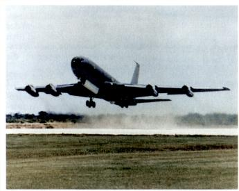
Abb. 3. Air Force / Army / Grumman Joint STARS E-8A. Der 24-feet-Radar-Sensor ist hinter dem Bugrad gut sichtbar.
