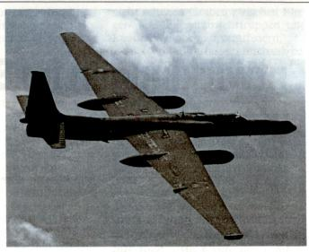
**Abb. 2. Taktisches Luftaufklärungsflugzeug der USAF, Lockheed U-2R.** (Länge 19,2 m; Spannweite 31,4 m; Höhe 5,2 m; Gipfelhöhe 21 400 m/M)
