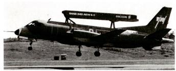
Radarüberwachungsflugzeug Erieye eingebaut in einem Verbindungsflugzeug Saab 340.
