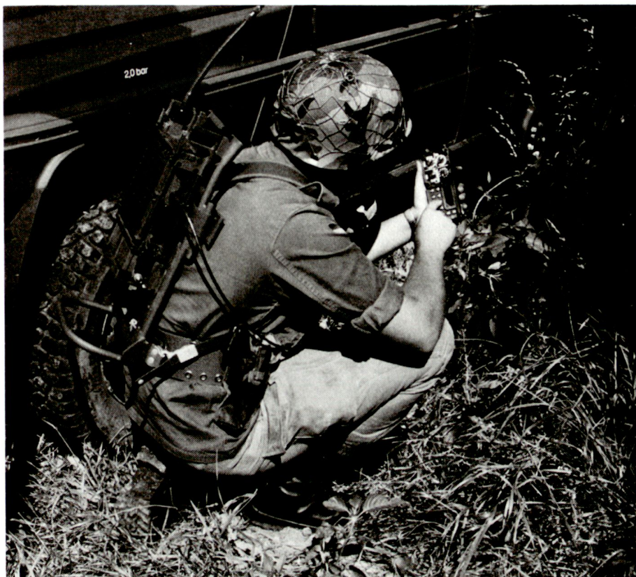
Tornisterfunkstation SEM 173, bestehend aus Tragevorrichtung, Sender/Empfänger, Batterie und abgesetztem Bedienteil (Aufnahme: Günter Pott)
