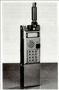
1-Watt-Handfunkgerät PR4G (Poste Radio 4e Génération)
