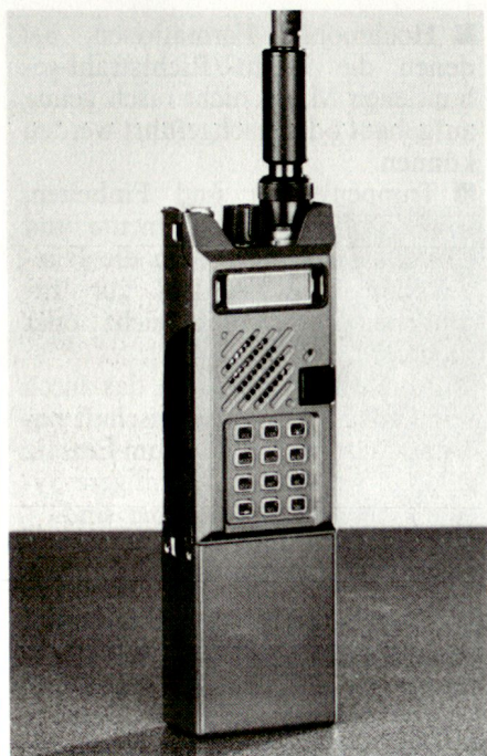
1-Watt-Handfunkgerät PR4G (Poste Radio 4 e Génération)
