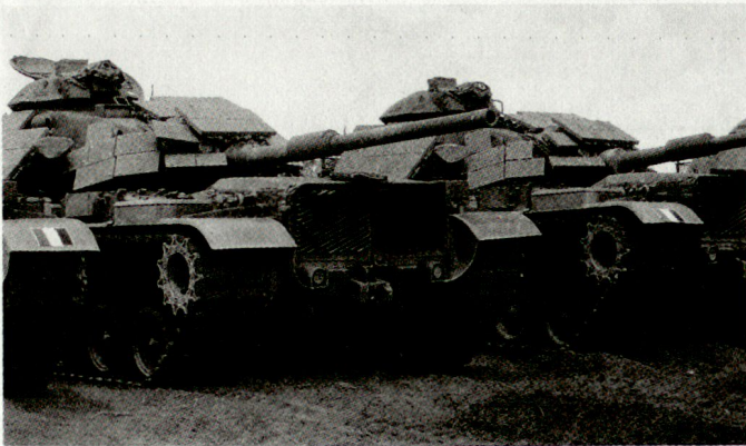
Um die Sicherheit italienischer Truppen in Somalia zu erhöhen, wurden an diversen Kampffahrzeugen Schutzverbesserungen vorgenommen. Bild: Kampfpanzer M60A1, ausgerüstet mit Reaktivpanzerung.
