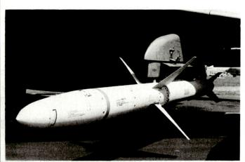
«HARM» (High-speed Anti-Radiation Missile) Anti-Radar-Lenkwaffe der USA wurde im Golfkrieg 1991 in grosser Zahl mit Erfolg gegen emittende Radarstationen eingesetzt.
