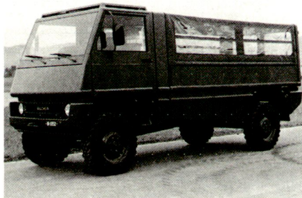
Der Militärlieferwagen 2 t «DURO», 4x4 geländegängig, 4-Gang-Automat. 6 Zyl, VM-Diesel, 110 kW bei 4200 U/min.
