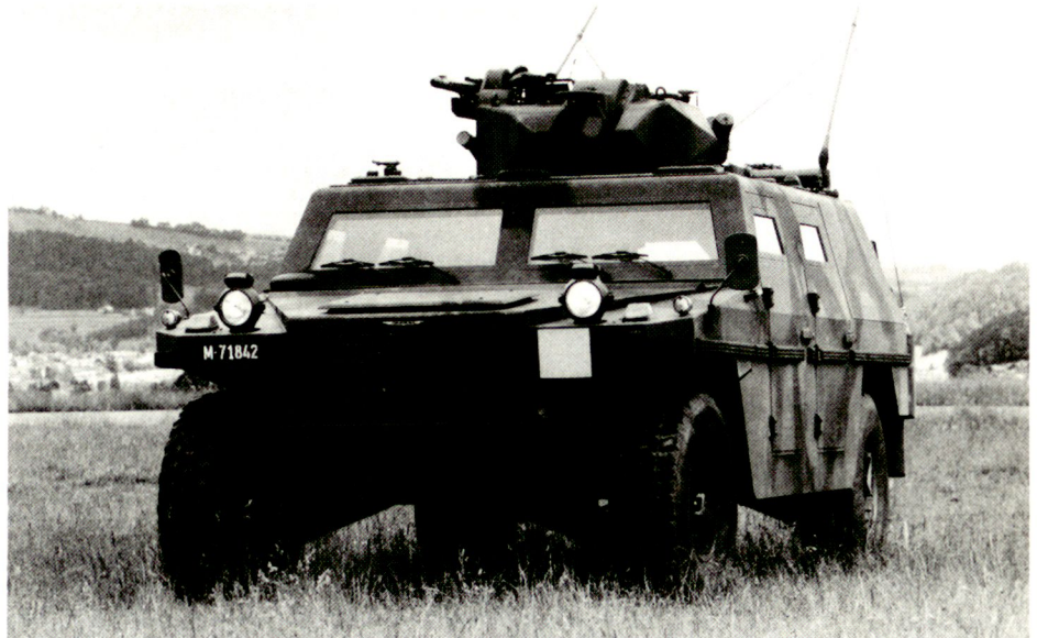
Leichtgepanzertes «Mowag»-Aufklärungsfahrzeug. Höchstgeschwindigkeit 105 km/h, Dieselmotortyp 6,2 Liter, 150 PS.
