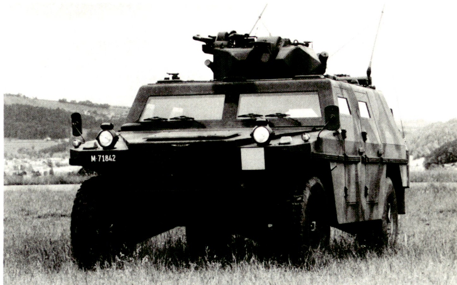
Leichtgepanzertes «Mowag»-Aufklärungsfahrzeug. Höchstgeschwindigkeit 105 km/h, Dieselmotortyp 6,2 Liter, 150 PS.
