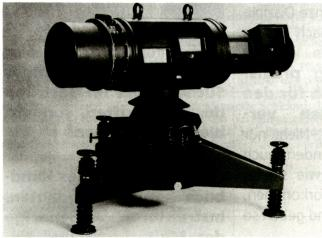
Prototyp des passiven Infrarot-Überwachungs- und Datenauswertesystems IRS-700.
