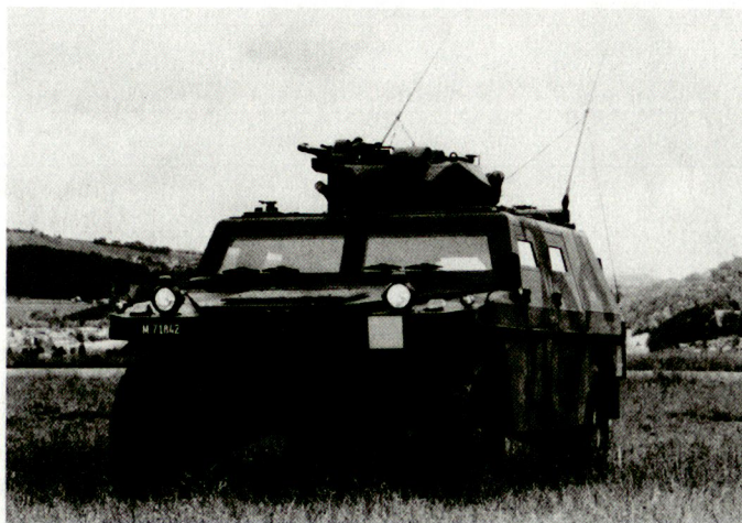
Leicht gepanzertes Aufklärungsfahrzeug mit drehbarer Beobachterkuppel, in die das Wärmebildgerät und ein Maschinengewehr 51 eingebaut werden können.
