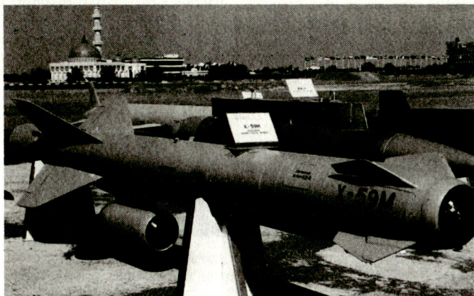
Ein weiteres Angebot der russischen Rüstungsindustrie: Marschflugkörper X59M, ausgerüstet mit TV-Lenkssystem.
