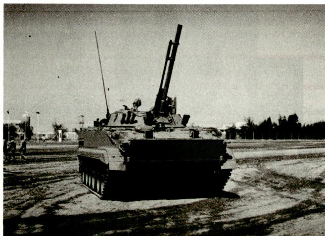
Russischer Kampfschützenpanzer BMP-3 in der verbesserten Version mit Wärmebildgerät: Gesamthaft sollen in den nächsten Jahren zirka 450 BMP-3 an die Emirate geliefert werden.
