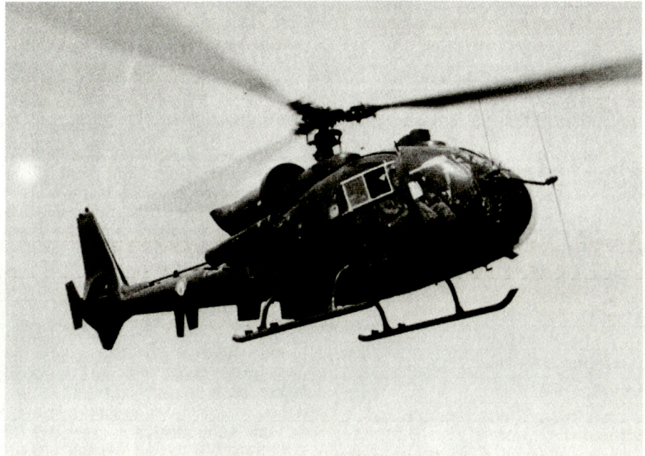
Hubschrauber Gazelle (Typenbezeichnung SA 342 M). Auf unserer Aufnahme mit Panzerabwehrraketen HOT (Haut subsonique, Optiquement Téléguidé) ausgerüstet. ■
