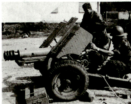
Gebirgskanone 76,2 mm aus ehemals jugoslawischer Produktion, hier im Einsatz mit kroatischen Truppen.
