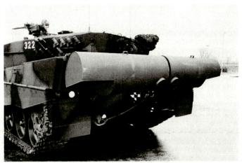
Kampfpanzer «Leopard» mit Triebwerk-Schalldämpfer.
